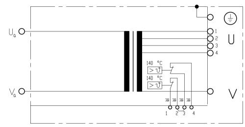
Klemme 1-2: 1 Temperaturwaechter sekundaer 140°C Klemme 3-4: 1 Temperaturwaechter Kuehlrohr 140°C
